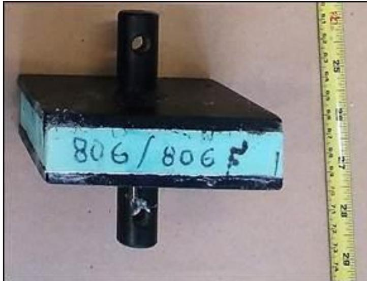
**Figura 1.** Probeta para el ensayo de tensión.
