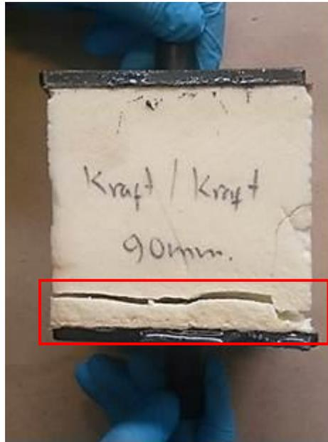
**Figura 4.** Muestra de la placa de poliuretano Kraft/Kraft piso espesor 90 mm después de haber sido realizado el ensayo de tensión. Rectángulo rojo: resalta la zona de falla en la espuma.
