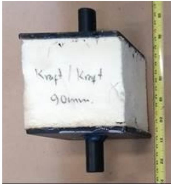
**Figura 1.** Probeta para el ensayo de tensión.
