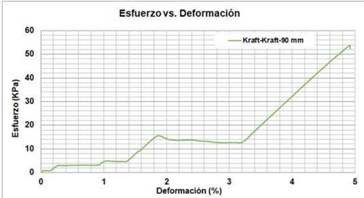
**Figura 3.** Curvas de esfuerzo (KPa) vs. deformación (%) de la muestra de la placa de poliuretano Kraft/Kraft piso espesor 90 mm.
